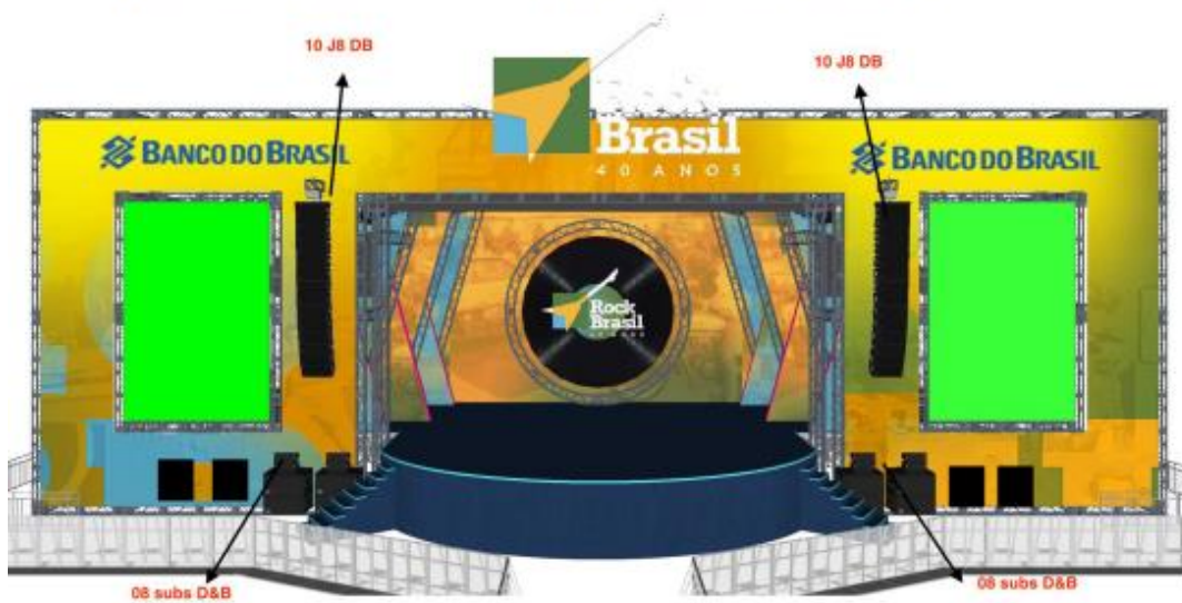
Fig 1C. Diagramação do palco com os dois Arrays na vertical e os subwoofers no piso.
