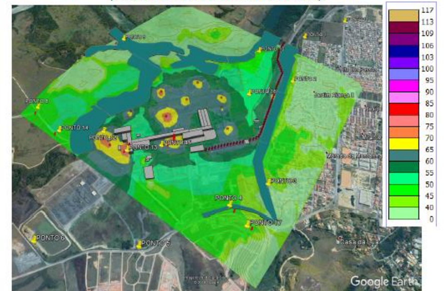
Figura 15B – Resultados das medições com a modelagem do ruído ambiental Leq,A relacionada as fontes internas fixas e móveis
